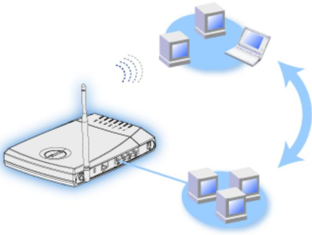
如果无线宽频路由器最多可以有**252**个用户。252个中的前**16**个用户可以无线连接。网络地址转换(NAT)允许**64**个用户同时连接到internet。它的运行速度是每秒**54M**字节，局域网的运行速度是**10/100Mbps**。宽频路由器和计算机之间的最大距离是**300英尺**。这个距离也依据您的具体情况而定。
